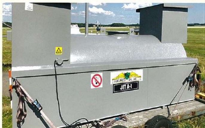
Scandinavian Österberg Helicopter Center: Mobil anläggning om 3m 3 med Hjelmco JET-A1. Lämplig för insats vid exempelvis skogsbrand.
